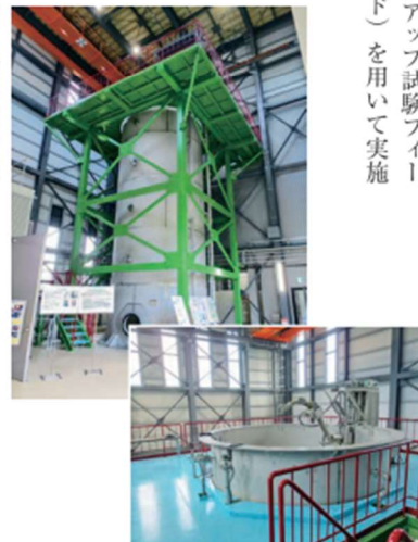
試験フィールドにある円筒型プール(写真上)とタンク内を上下に昇降可能な多関節マニピュレータ(写真下)
