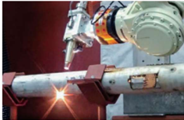
過去に実施してきた遠隔操作による水中レーザー切断試験状況
